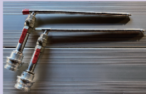
Fognail刺針式噴霧喉筆重約1.2公斤，長約0.52米，刺針部分直徑約18毫米，可以在6至50巴壓力下工作；分為防衛型（上）及進攻型（下）兩種型號。
